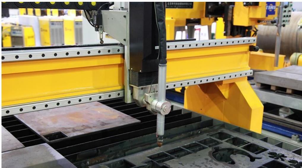
等离子切割机的易损件主要包括有电极、电咀、保护套及分配器，为了节约客户的成本，那么如何延长这些易损件的使用时间呢？
